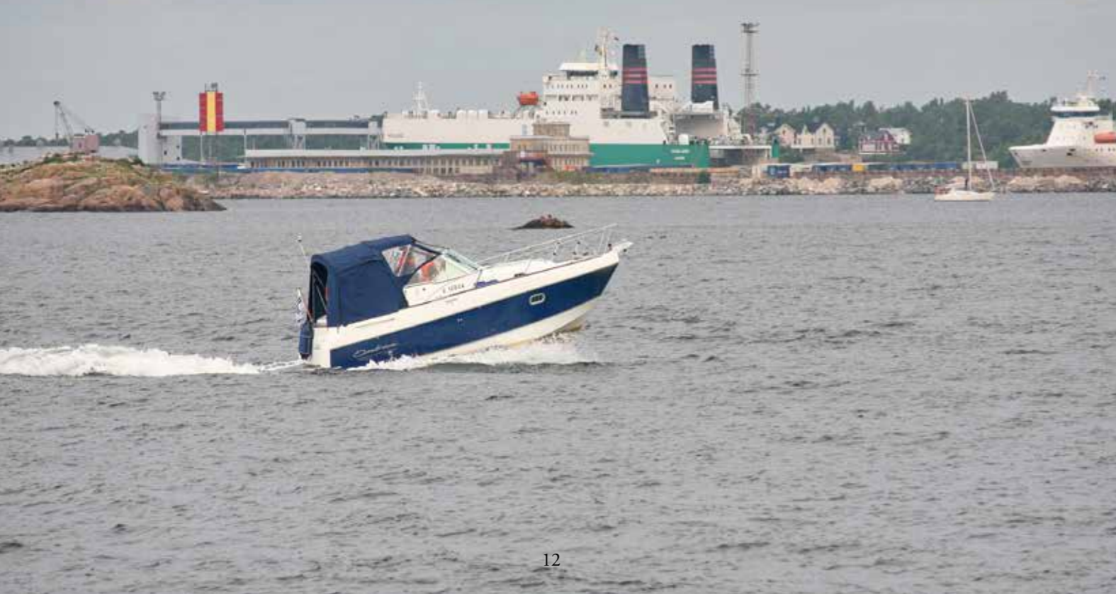
Juuri liukukynnyksellä polttoaineen kulutus on suurinta, sillä vene kulkee kuin ylämäkeen. Kuva: Pasi Pouri
