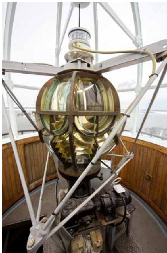
Linssistön päällä näkyy tarvittaessa automaattisesti syttyvä varavallo. Kuvat: Markku Tamminen
