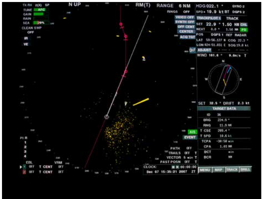
Helsingin majakalla olevan tutkamajakan (racon) jälki (keltainen viiva) erottuu selkeästi merenkulikututkalla. Kuva: Markku Tamminen
