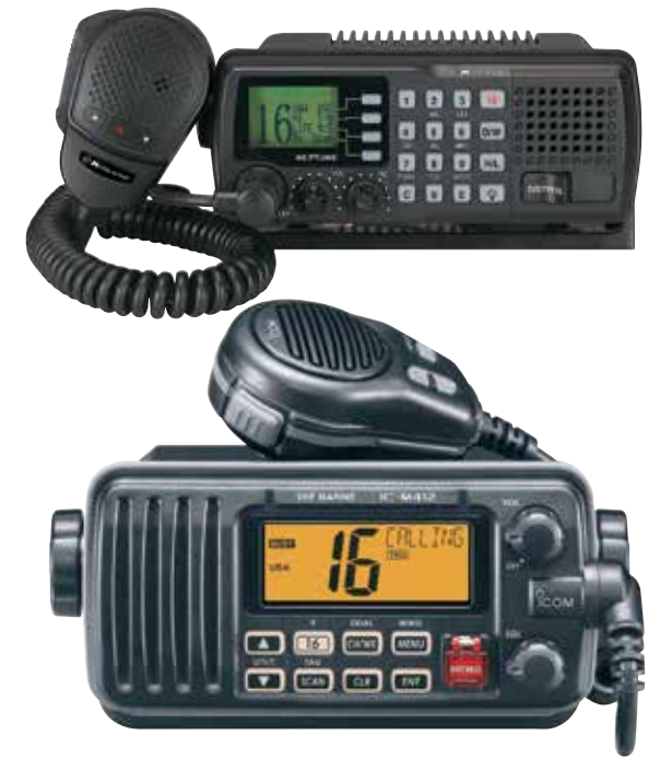
Meri-VHF varustettuna DSC-ominaisuudella on hyvä väline hätäilmoituksen tekoon ulkomerellä koko Itämeren alueella. Radioverkkojen avulla pelastajat pystyvät kommunikoimaan meri-VHF:n avulla kaukaa. Sen sijaan sisävesillä meri-VHF soveltuu huonosti, sillä järville ei ole rakennettu kattavaa meri-VHF-radioverkkoa Saimaata lukuun ottamatta.
