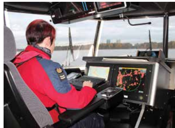
Esbo Sjöräddares RB Emmi har skilda skärmar för radare och navigationsprogram.
