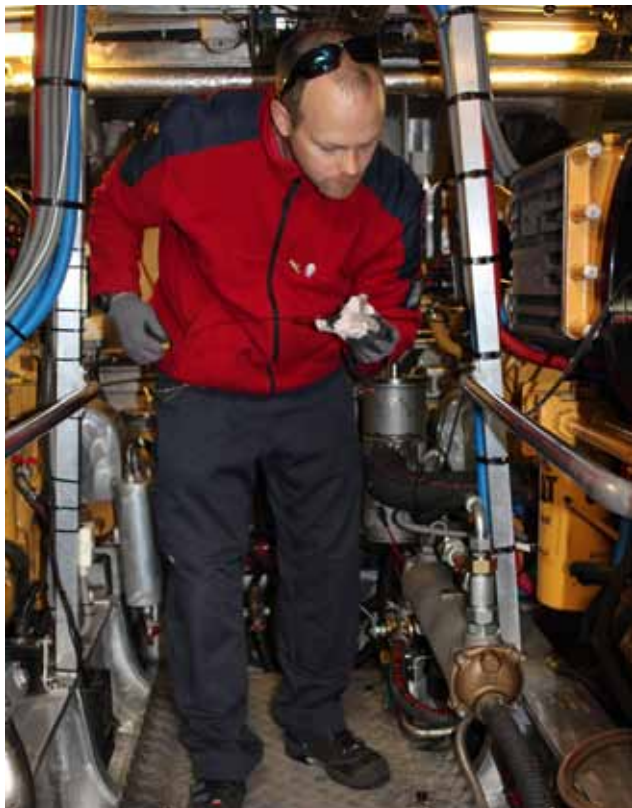
Oskar Krogell kontrollerar oljemängden på RB Rautauoma. Kontrollen av motoroljan är en central del av start- och slutkontrollerna. Kontrollerna görs enligt listor så att alla punkter säkert blir beaktade
