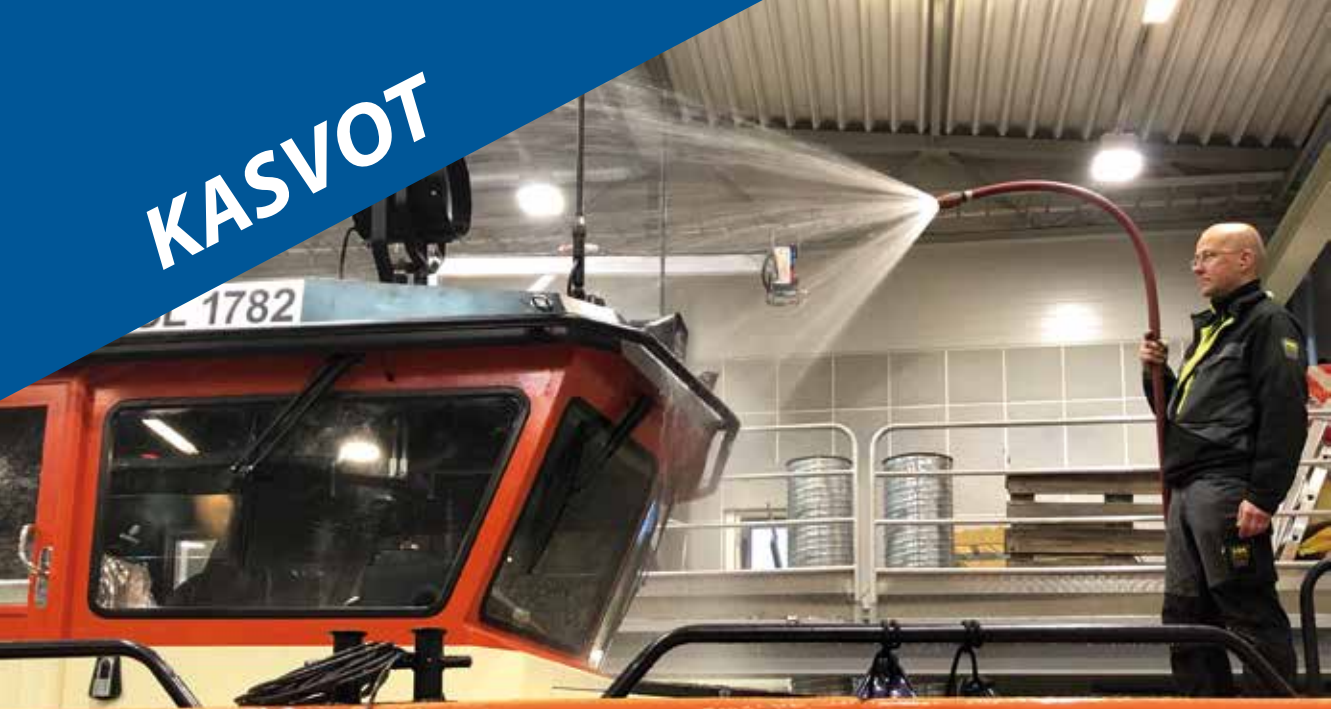
Ennen vastaanottoa jokaiselle pelastusveneelle tehdään tarkat vastaanottotarkastukset. Tässä Lasse tarkastaa PV Aiskon ohjaamon vesitiiveyttä.
