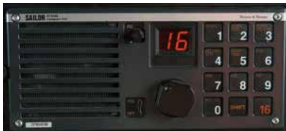
Perinteinen meri-VHF, joka on asetettu kuuntelemaan hätä- ja kutsukanavaa 16. Keskellä alhaalla on äänenvoimakkuuden säädin ja kaiuttimen vieressä SQ -säätimellä säädetään radiosata tulevaa kohinaa. Kanavalle 16 on pikavalinta.
