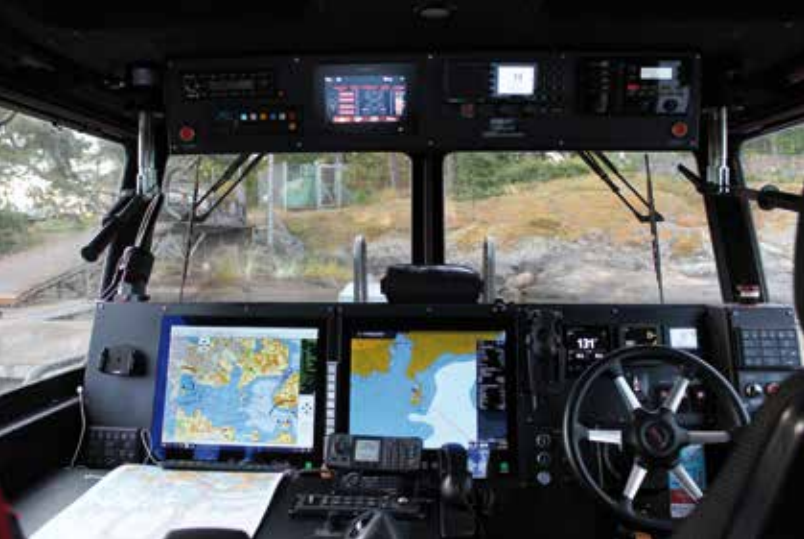
Päänavigointivälineenä on Furunon Time Zero ja navigointiohjelmisto. Niiden suuret näytöt hallitsevat ohjaamoa
