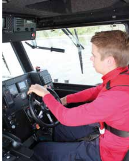
Ruorimiehellä on jousitettu penkki, sähköhydraulinen ruori sekä kaikki hallintalaitteet käden ulottuvilla
