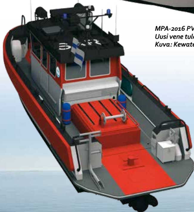
MPA-2016 PV 2 Diesel Render 3 20181005 Lähellä vedenpintaa oleva takakansi mahdollistaa hyvän työskentelyn pelastettaessa ihmisiä vedestä kuin myös hinauksissa ja karilta irrotuksissa. Kuva: Kewatec Aluboot
