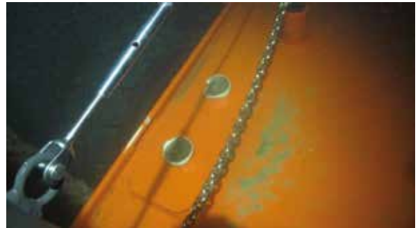
Peräpollari repeytyi pelastustoimien aikana irti, kun venettä yritettiin vakauttaa pinnalla. Kuva on otettu luotsiveneestä, sen ollessa meren pohjassa.
