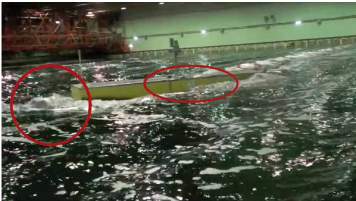
Allaskokeissa selvitettiin, että tankkilaivan perään muodostui erittäin jyrkkä ja korkea aallokko, johon luotsivene joutui. Kuva: Onnettomuustutkintakeskus
