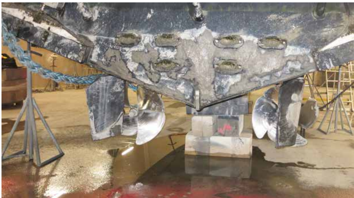
Veneen peräsimet olivat jyrkästi käännettyinä, jotka aiheuttivat vääntömomentin kallistuneelle veneelle.
