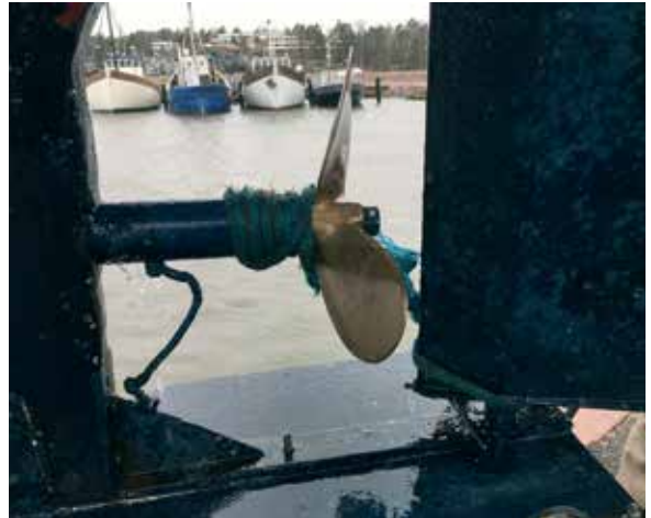
Kauden ensimmäisessä tehtävässä arviolta 200 metriä köyttä oli takertunut moottoriveneen potkuriakselin ympärille. Kuva: Mikael Andersén
